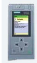
SIMATIC S7-1500 F PLC 是 S7-1500 PLC 家族中的一员，用于有功能安全要求的应用场合，它除了拥有普通 S7-1500 所有特点外，还集成了安全功能，可支持到 SIL3/PL e 安全完整性等级，符合 IEC 61508、IEC62061、ISO 13849-1、GB 20438、GB 20830 等国际和国内安全标准，其将安全技术轻松地 and 标准自动化合二为一，无缝地集成在一起。
